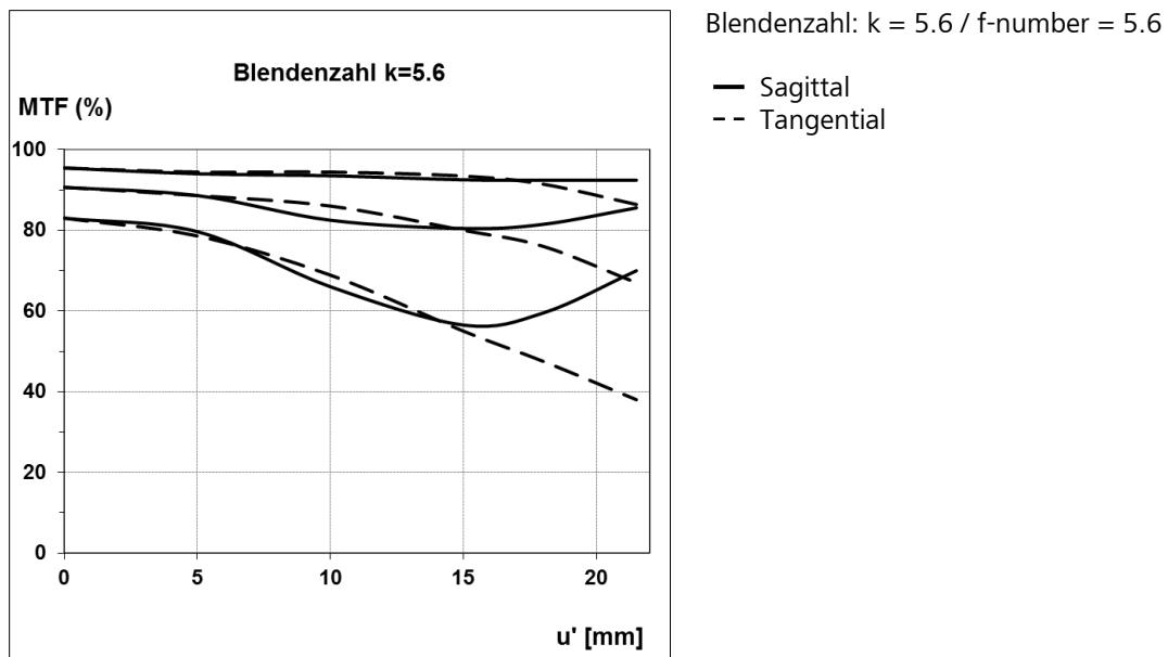
Modulationsübertragung MTF als Funktion der Bildhöhe ( $u'$ ) und Spaltorientierung. Weißes Licht. Ortsfrequenzen R=10, 20 und 40 Perioden/mm. // Modulation transfer MTF as a function of the image height ( $u'$ ) and slit orientation. White light. Spatial frequencies R=10, 20 and 40 cycles/mm.
